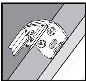
**Montáž na rám okna (pomocí stěnového úhelníku)**
